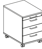
9 HU Height 592, width 430, depth 600/800 mm
